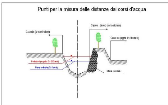
Figura 1 - Sezione tipo di alveo fluviale con individuazione dei punti per la misurazione delle distanze
